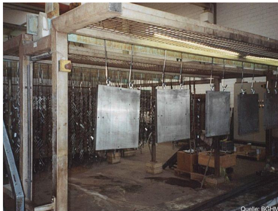
1.1.3 Vollautomat Werkstücke auf Warenträger (Gestelle)
